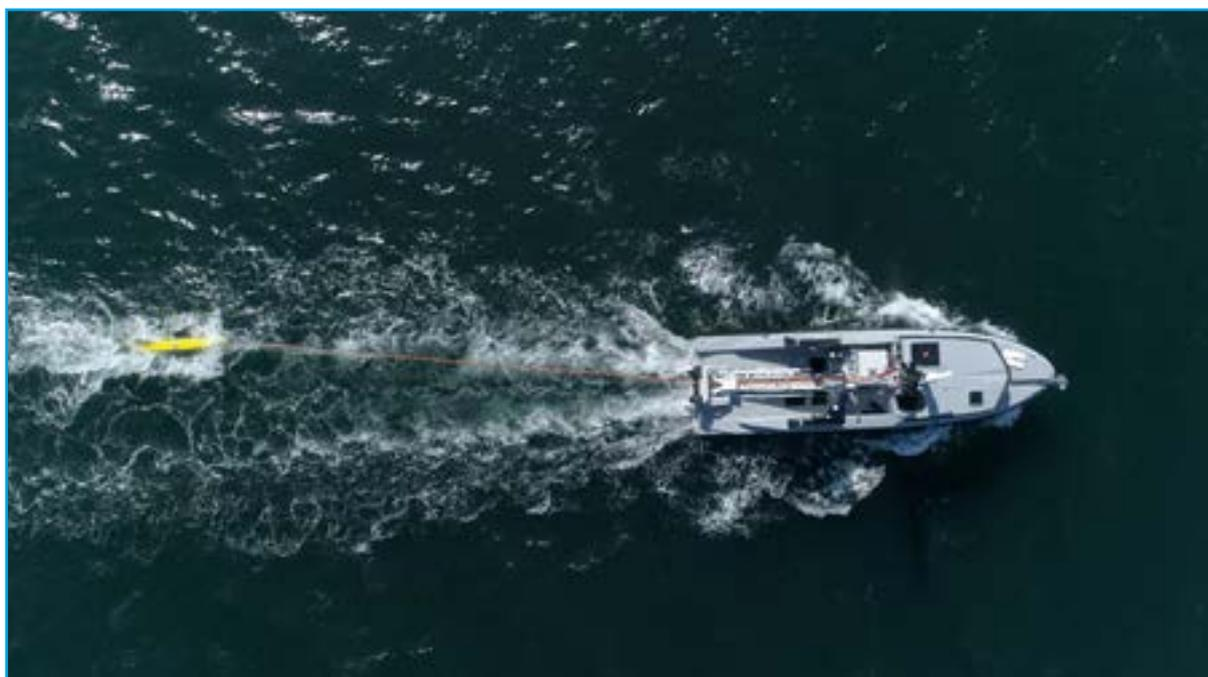
Figure 1 : Exemple d'USV porteur d'UUV. Source : Thales
